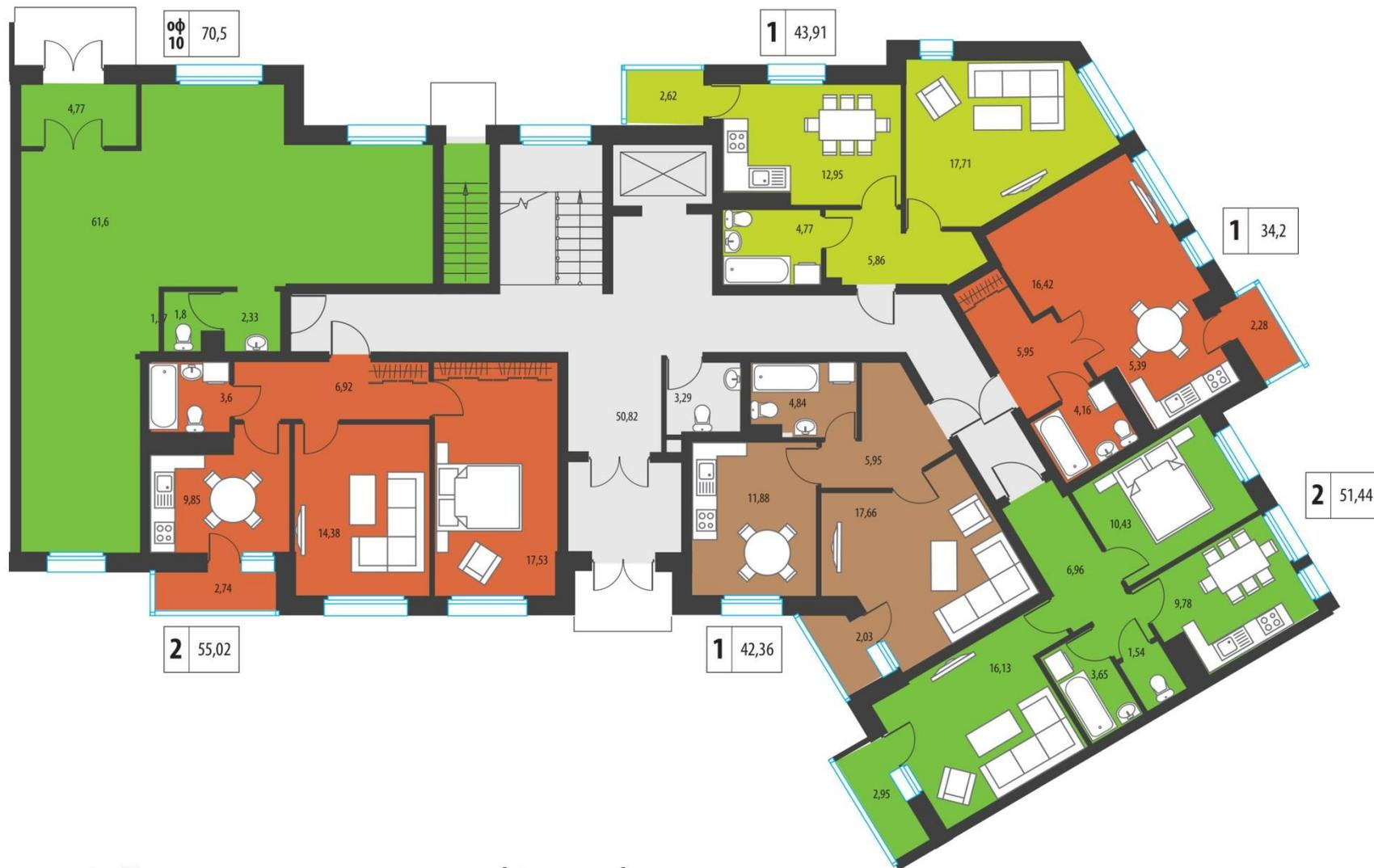
Секция 4. План типового этажа (1 этаж)
